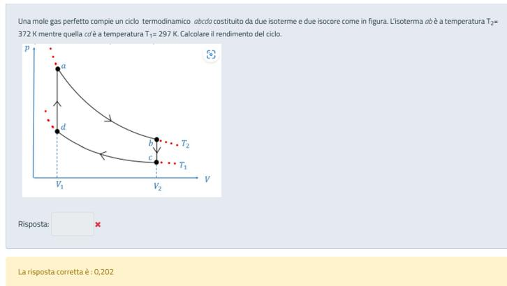
Figure 149: Calcolo del rendimento del ciclo termodinamico
