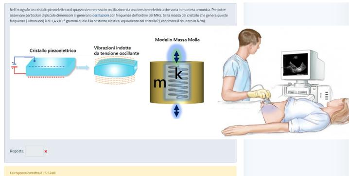
Figure 124: Calcolo della costante elastica equivalente
