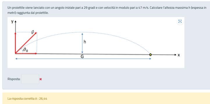
Figure 9: Calcolo dell'altezza massima raggiunta da un proiettile
