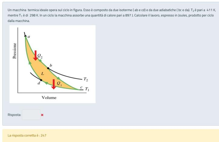
Figure 144: Calcolo del lavoro prodotto per ciclo da una macchina termica ideale
